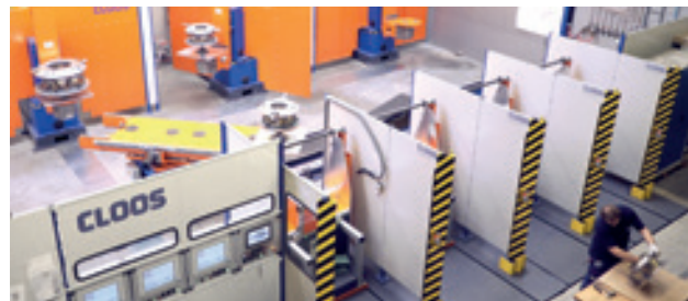
Bild 2: Die verkettete Roboteranlage verfügt über vier Be- und Entladestationen sowie drei Schweißzellen.
