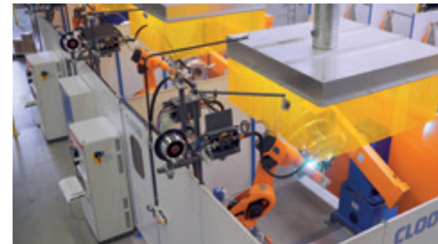
Bild 5: Die Roboter in den drei baugleichen Zellen schweißen mehr als doppelt so schnell wie ein Handschweißer.
